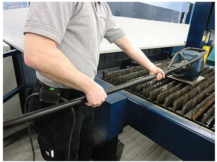
Interruptor de desactivação no cabo
