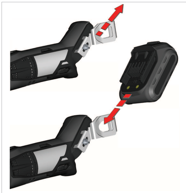
Sustitución del acumulador
