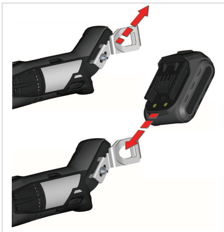
Remplacement de la batterie
