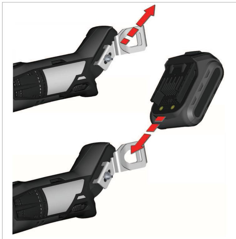
Sostituzione della batteria ricaricabile
