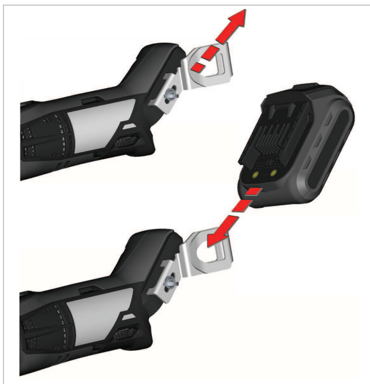
Substituir a bateria
