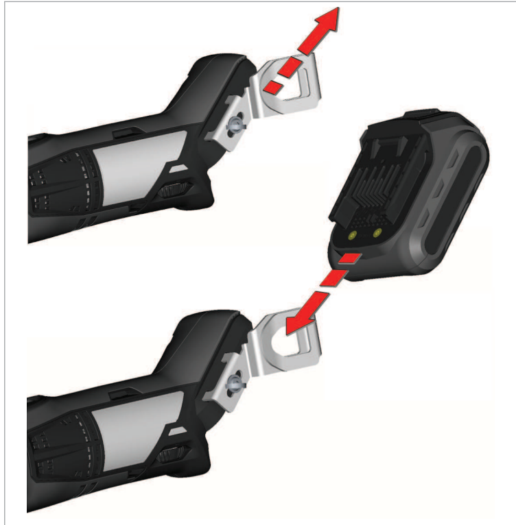
Sustitución del acumulador
