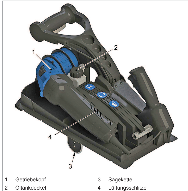
Wartungsstellen am Panel Cutter TPC 165
