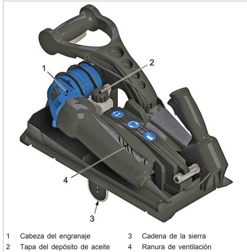
Puntos de mantenimiento en Panel Cutter TPC 165
