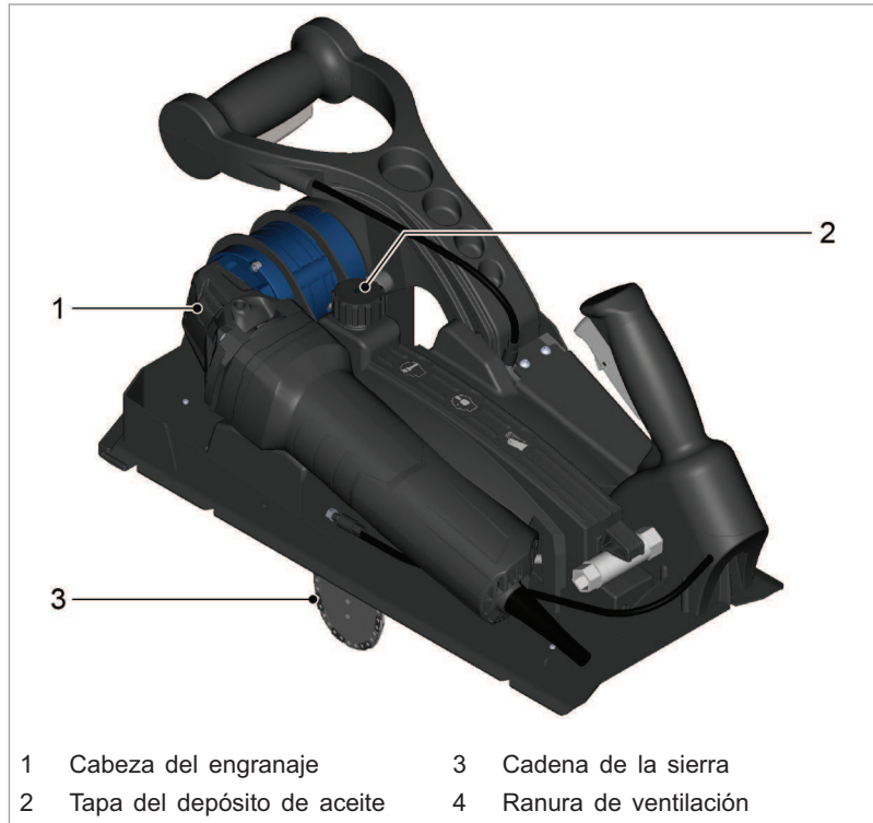
Puntos de mantenimiento en Panel Cutter TPC 165
