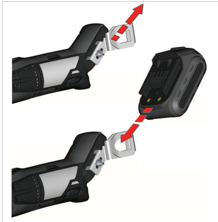
Sustitución del acumulador
