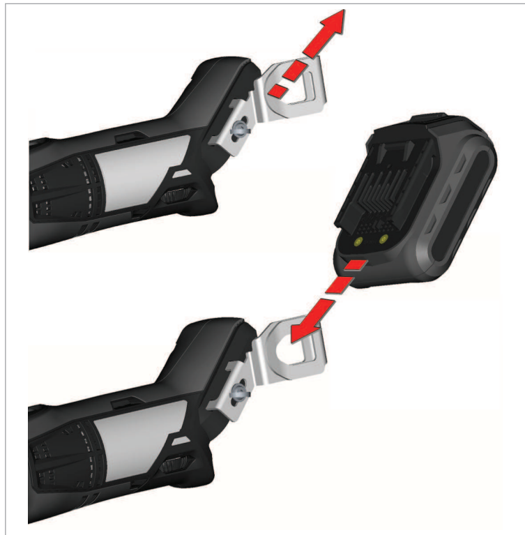
Remplacement de la batterie
